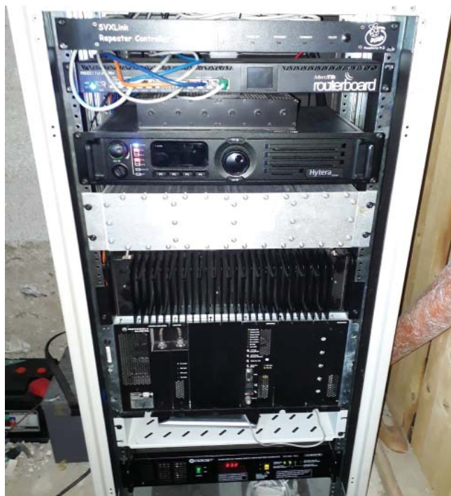
Repetitorska postaja na Kumu – zgoraj krmilnik repetitorja, usmerjevalnik za linkovske zveze, duplekser, Hytera DMR repetitor, duplekser, končna stopnja in pod njo analogni repetitor, vremenska postaja in napajalnik z UPS-om.
