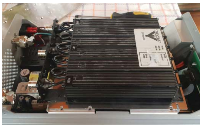
Dupleks filter pripravljen za vgradnjo v repetitor
