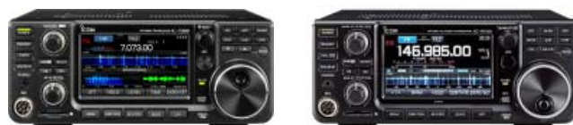
Slika 06.03.17 SDR bratca - prva komercialna SDR KV radijska postaja KV/50/70MHz z direktnim vzorčenjem ter prva UKV radijska postaja z direktnim vzorčenjem 144/432 ter Down konverzija na 1296MHz
